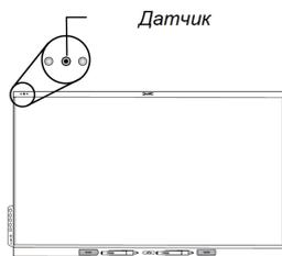
Датчик присутствия расположен в левом верхнем углу рамки дисплея.
