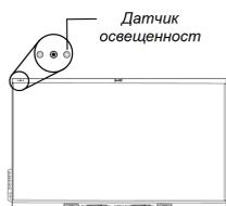
Датчик освещенности расположен в левом верхнем углу рамки дисплея.
